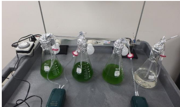
Figura 3. Cultivo de Chlorella vulgaris en fotobiorreactores a los 13 días
