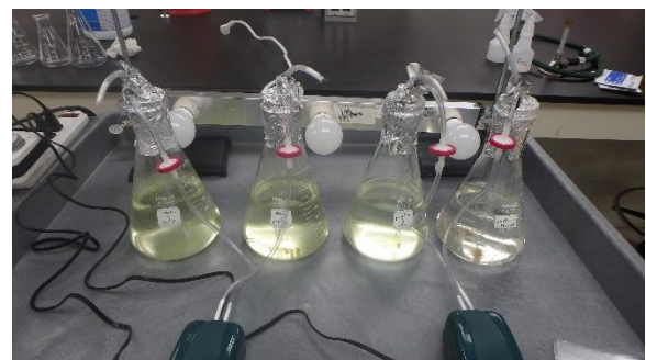
Figura 2. Inoculación de Chlorella vulgaris en fotobiorreactores (Día 0)
